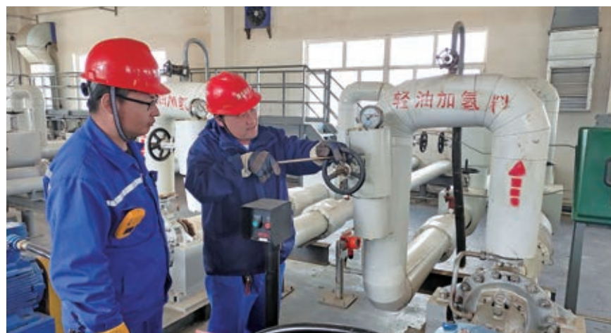
赤峰博元员工规范操作 调节轻油加氢进料量
